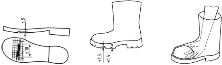
d) Dış tabanda çatlaklar
