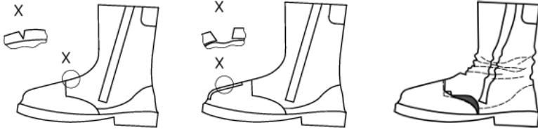
a) Sayada derin çatlaklar
